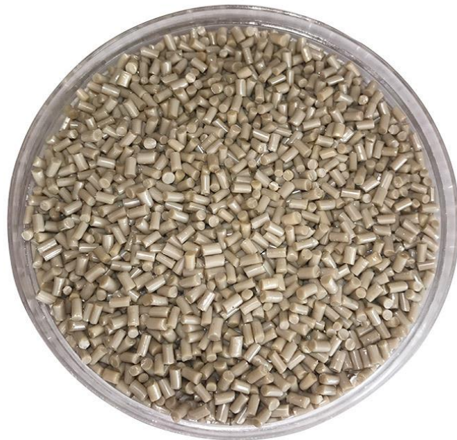
图 2 图 1 进口（英国维格斯）聚醚醚酮（PEEK）标准料
